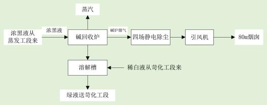
图2.1-7 碱回收燃烧工艺流程图
