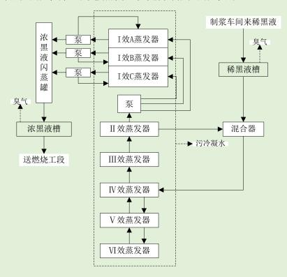
图2.1-6 碱回收蒸发工段工艺流程及产污节点图
