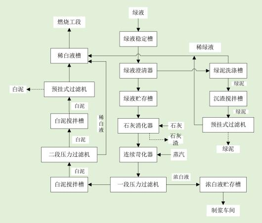
图2.1-8 碱回收苛化工段流程及产污节点图
