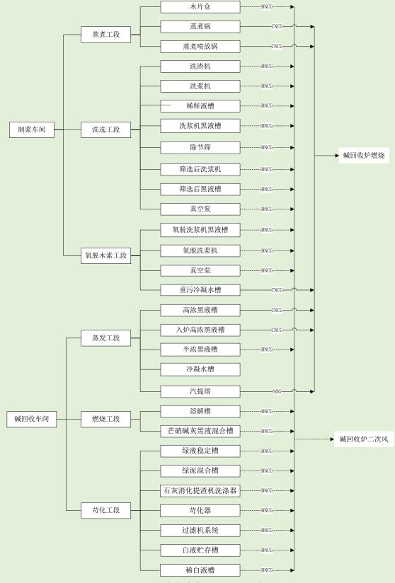
图2.3-17 臭气收集处理工艺路线图
