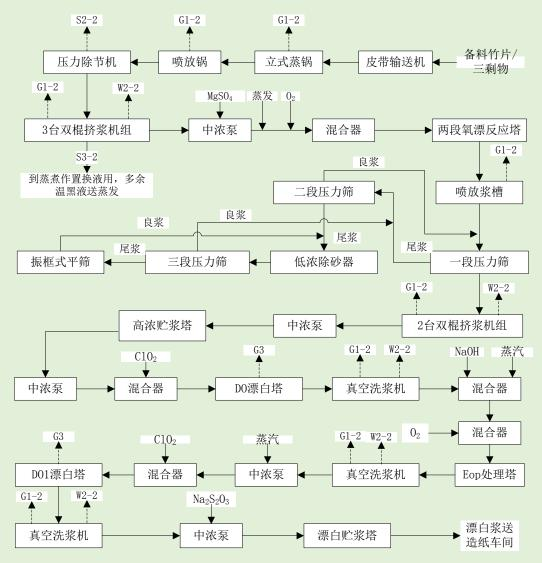
图2.3-5 二期制浆工艺流程及产污节点图
