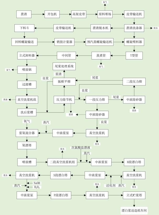
图2.1-4 原有工程制浆工艺流程及产污节点图
