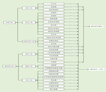
图2.3-8 一期碱回收蒸发工段工艺流程及产污节点图
