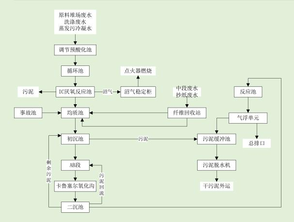
图2.1-9 原有污水处理站工艺流程图
