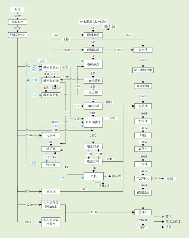
图2.1-2 原有工程水平衡图
