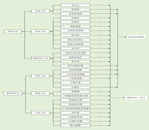
图2.3-10 一期碱回收苛化工段工艺流程及产污节点图
