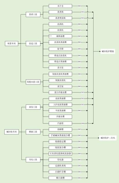
图2.3-15 生活用纸工艺流程及产污节点图
