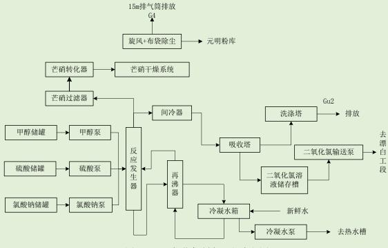
图2.3-7 二氧化氯制备工艺流程图
