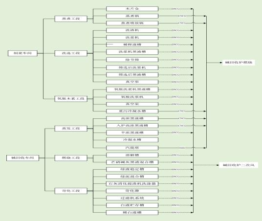
图2.3-13 二期碱回收苛化工段工艺流程及产污节点图
