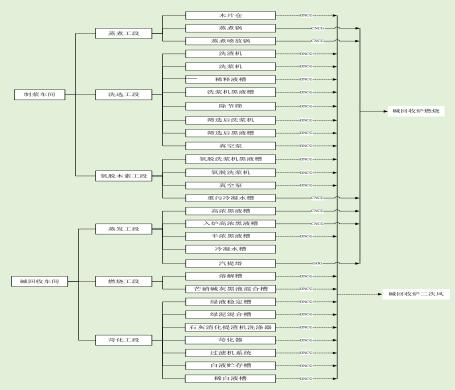
图2.3-11 二期碱回收蒸发工段工艺流程及产污节点图
